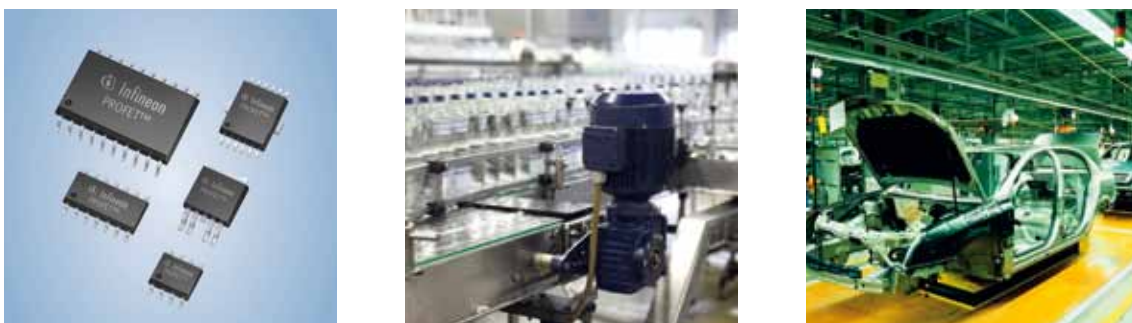
Abbildung 5: Leistungshalbleiter-Komponenten wie die Industrial-PROFET™-Serie von geschützten High-Side-Schaltern können extrem hohe Energien verarbeiten und eignen sich somit ideal zum Schalten von induktiven Lasten und zum Ansteuern von Relais – selbst im erweiterten Temperaturbereich von -40 bis 125 °C.
